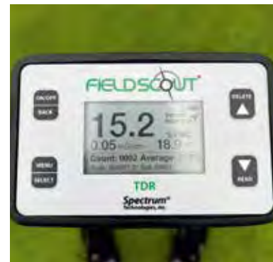
Spectrum TDR - Messgerät für Bodenfeuchte, Salzgehalt und Oberflächentemperatur
