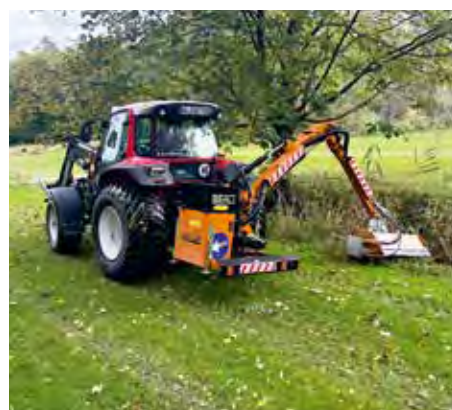
Berti Auslegemäher mit Mulchkopf und Heckenschere
